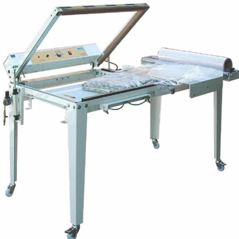
La embolsadora Artmecc NIB 08 neumática de soldadura en L se utiliza para empaquetar ropa plana de lavandería a partir de plástico en bobina de semitubo (abierto por un lado), pudiendo realizar paquetes con una altura de hasta 50 cm. El funcionamiento neumático se activa mediante la activación de dos pulsadores, lo que hace bajar el marco para realizar la soldadura y sube al presionar de nuevo los pulsadores una vez la bolsa ya está soldada.
