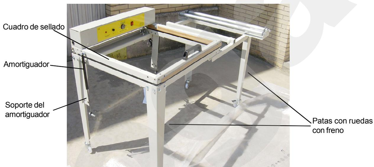
Con la máquina ya aguantada por sus 4 patas montaremos el sistema de amortiguadores que elevan el cuadro de sellado.
